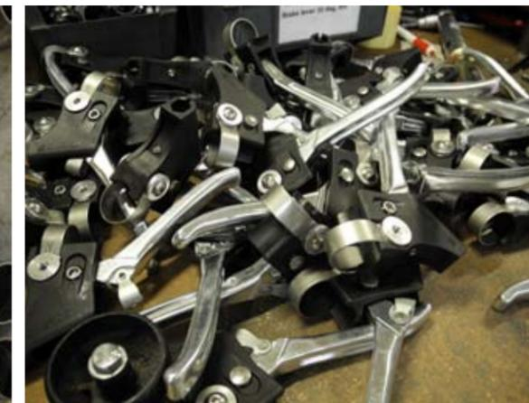
Alle Teile am Brompton wie hier die Bremsgriffe aber auch Scharniere, Knebelschrauben oder Gepäckträger-Rollen sind eigenentwickelt und werden von kleinen Betrieben in der Nähe produziert.
